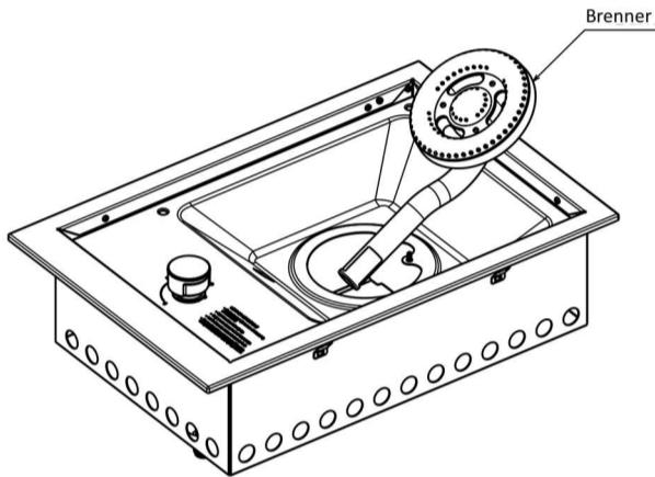
4. Ersetzen Sie den Injektor durch einen Injektor geeigneter Größe (siehe Gasspezifikationstabelle auf Seite 6).
