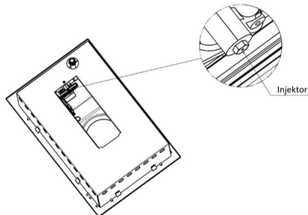
5. Stellen Sie den Primärluftverschluss (falls erforderlich) ein, indem Sie die Einstellschraube und den Drehverschluss lösen, um die gewünschte Spaltgröße zu erreichen. Siehe "Primärluft" in der Gasspezifikationstabelle auf Seite 6 für die empfohlenen Abstände je Gasart.
