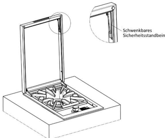
Beim Schließen des Deckel schwenkt das Sicherheitsbein vorne und stoppt auf der Kante, um ein Schließen des Deckels zu verhindern. Nachdem sichergestellt wurde dass das Gas ausgeschaltet wurde, muss der Fuß zum vollständigen Schließen des Deckels nach innen gedrückt werden
