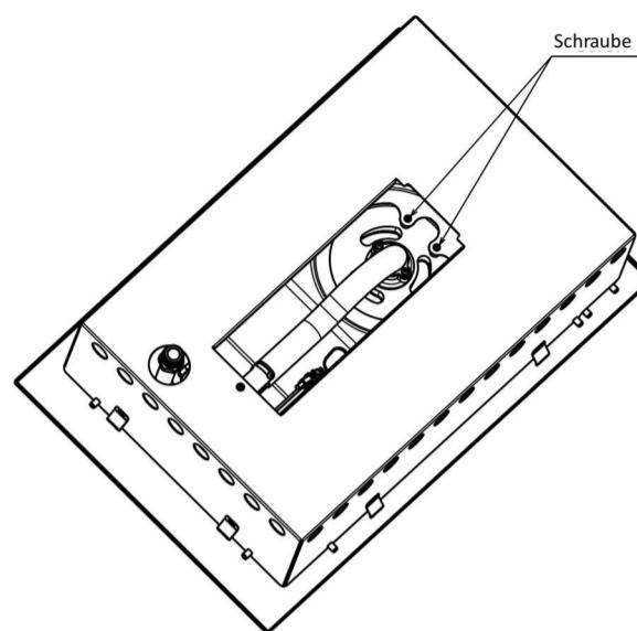
3. Entfernen Sie den Brenner aus dem Brennergehäuse.
