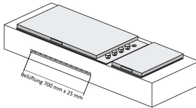
Bei einer Installation des Einbauseitenbrenners mit dem Einbaugrill kann die Belüftung des Seitenbrenners über eine gemeinsame Lüftung (wie oben gezeigt) erreicht werden. Vorausgesetzt, dass keine Einschränkung der Luftströmung in der Gehäusekonstruktion besteht (keine Trennplatte zwischen Grill und Seitenbrenner).
