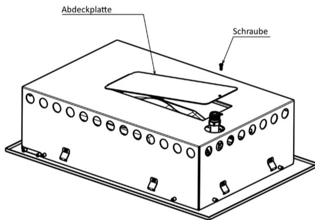
2. Entfernen Sie die Befestigungsschrauben am Brenner.
