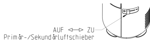
Fig. 4: régler l'arrivée d'air
